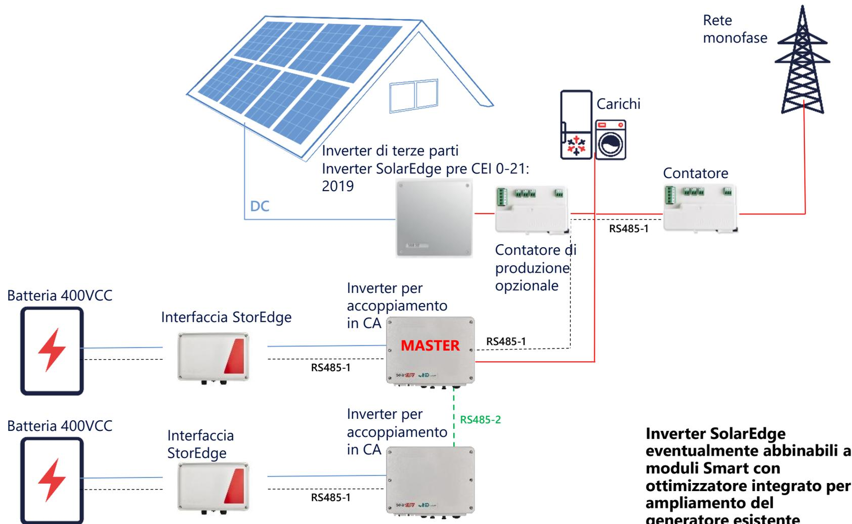
**Inverter SolarEdge eventualmente abbinabili a moduli Smart con ottimizzatore integrato per ampliamento del generatore esistente**
