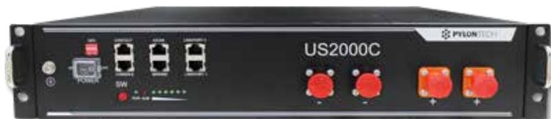
Ciascun elemento, da 50 Ah e di altezza 2 unità rack, viene facilmente installato in appositi armadi rack forniti su richiesta da Energy Srl.
