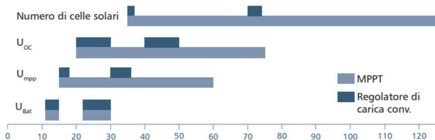
In confronto ai regolatori di carica senza MPPT, gli inseguitori MPP possono essere utilizzati per un ampio campo modulare. Con un inseguitore MPP non si dipende più dalla tensione del modulo e dalla grandezza delle stringhe. La tensione del modulo può differire di molto dalla tensione della batteria.
