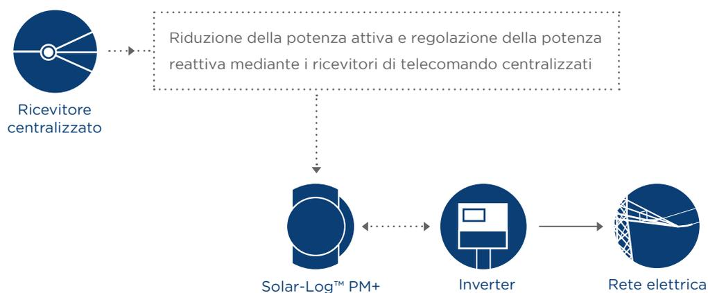
La gestione Feed-In semplificata è realizzabile anche mediante la funzione "telecomandata con calcolo dell'autoconsumo". Per fare ciò è sufficiente misurare il consumo momentaneo con un contatore.
