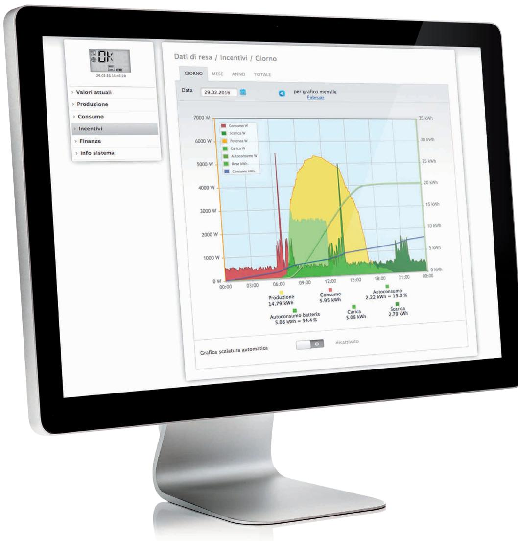
**Sintesi giornaliera:** la batteria viene ricaricata dalla produzione eccedente dell'impianto fotovoltaico (verde chiaro) e in caso di necessità scaricata (verde scuro) per evitare il prelievo di energia dalla rete.
