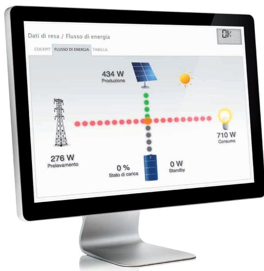
Mediante il flusso di energia è possibile visualizzare l'utilizzo della corrente prodotta.
