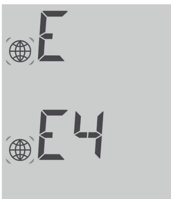
Fig. : Exemple de codes clignotants pour Internet – Erreur 4
