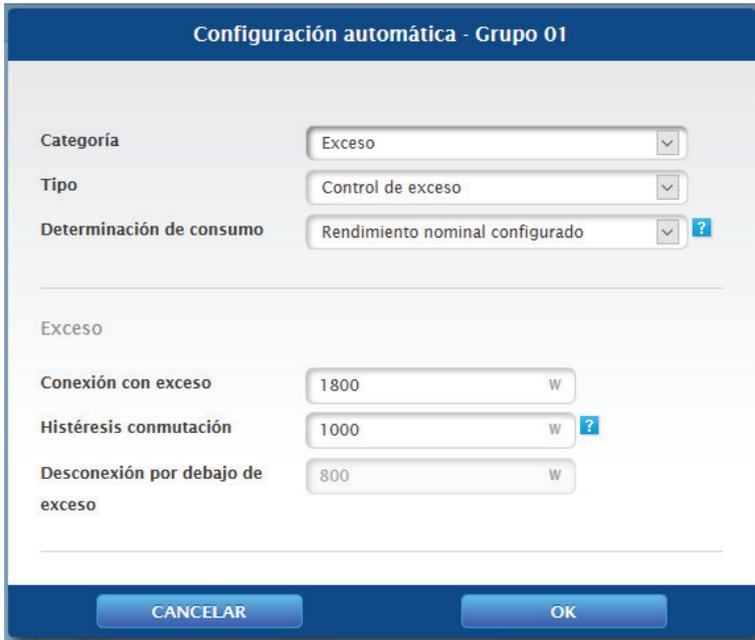
Fig.: Ventana de configuración de la lógica de control
