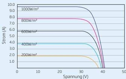
**P-V KURVEN DES PV-MODULS (305W)**
