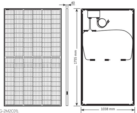
\* Las dimensiones y el peso que se muestran en esta tabla aplican a los módulos fabricados a partir de febrero de 2021 (SPVxxx-R60DWMG-2M2C01). Los módulos fabricados antes de febrero de 2021 (SPVxxx-R60DWMG-2C01) tienen unas dimensiones de 1776 x 1052 x 40 mm y pesan 23,0 kg
