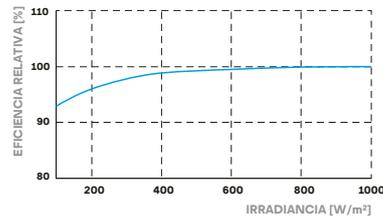
Típica potencia del módulo en condiciones de irradiancia bajas en comparación con las condiciones STC (25°C, 1000 W/m<sup>2</sup>).
