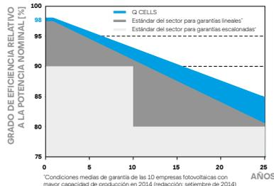
Un mínimo del 98% de la potencia nominal en el primer año. Después, un máximo del 0,54% de degradación anual. Un mínimo del 93,1% de la potencia nominal tras 10 años. Un mínimo del 85% de la potencia nominal tras 25 años. Todos los datos se encuentran dentro de las tolerancias de medición. Garantías de acuerdo con los términos de garantía de la organización de ventas de Q CELLS del respectivo país.
