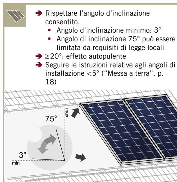
**Fig. 2:** Opzioni d'installazione per i moduli Q CELLS in silicio cristallino. Tutte le dimensioni sono in mm. Rispettare anche i carichi massimi statici consentiti e le aree di bloccaggio come specificato alla pagina seguente. Le opzioni d'installazione illustrate si applicano a moduli sia con orientamento verticale sia con orientamento orizzontale.
