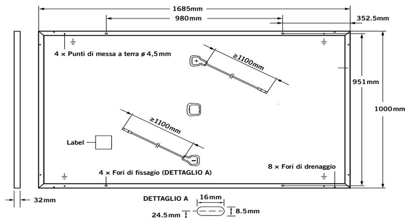
**Fig. 1:** Dimensioni esterne (in mm) e componenti per i moduli Q.PEAK DUO-G5.X, Q.PEAK DUO BLK-G5.X,
