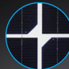
Q.ANTUM DUO combina un'avanzata tecnologia di separazione delle celle e un'innovativa interconnessione con Q.ANTUM Technology
