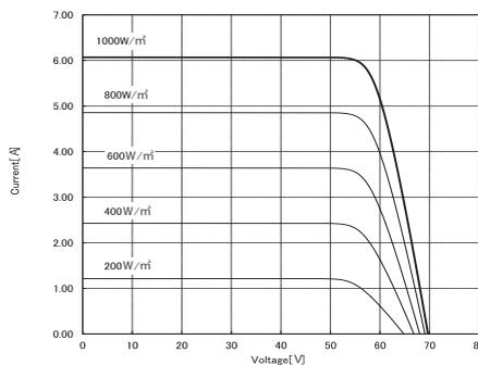
Dati di riferimento per il modello: VBHN330SJ53 (Temperatura delle celle: 25 °C)
