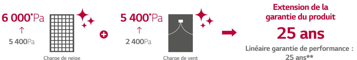
\* Les modules répondent aux exigences de la nouvelle version de la norme IEC 61215 : 2016 qui confirme 5 400Pa en face avant et 4 000Pa en face arrière. LG a réalisé des tests internes et confirme 6 000Pa/5 400Pa. \*\* 1) 1ère année : 98 % 2) Après la 2ème année : 0,33 % dégradation annuelle. 3) 90,08 % après 25 ans.
