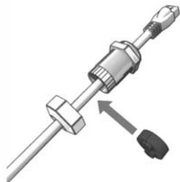
Figura 2.22 Inserimento del cavo attraverso il passacavo
