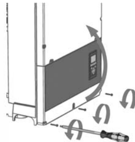
Abbildung 2.15 Vordere Schrauben lösen und Abdeckung anheben
