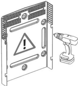
Abbildung 2.10 Montage der Wandhalterung
