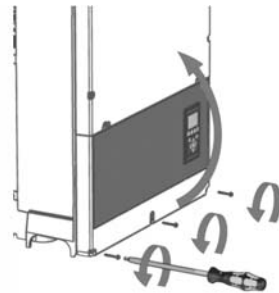
Imagen 2.15. Afloje los tornillos frontales y levante la cubierta
