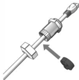
Imagen 2.22. Recorrido de los cables a través de los racores atornillados para cables
