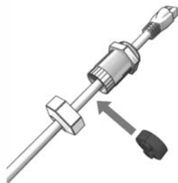
Figure 2.22 : Acheminer les câbles dans les presse-étoupes
