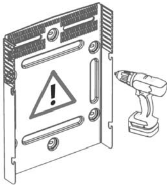
Imagen 2.10. instalación del soporte mural
