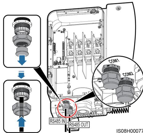
**Paso 3** Extraiga la base de terminales del cable de la regleta de conexión y conecte el cable de comunicaciones a dicha base.
