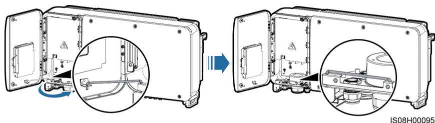
**Paso 3** Cierre la puerta del compartimento de mantenimiento y ajuste los dos tornillos de la puerta.
