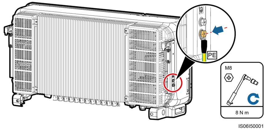
**Paso 3** (Opcional) Para mejorar la resistencia a la corrosión de un borne de tierra, aplique gel de sílice o pintura alrededor del terminal.
