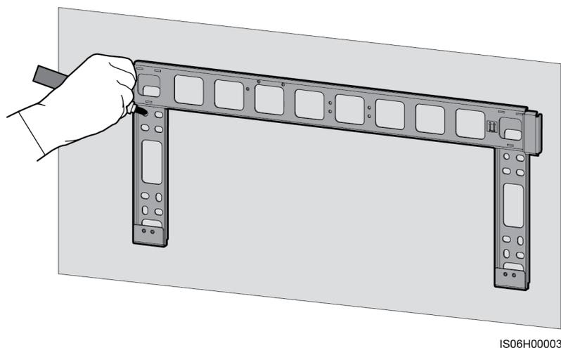
**Paso 2** Perfore orificios usando un taladro de percusión e instale pernos de expansión.
