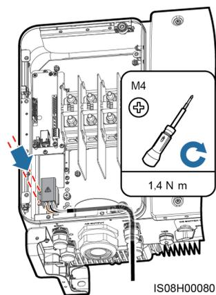
**Paso 6** Enlace el cable de alimentación del seguidor solar.
