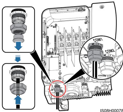
**Paso 3** Inserte el conector RJ45 en el puerto de red RJ45 que se encuentra en el compartimento de mantenimiento del SUN2000.
