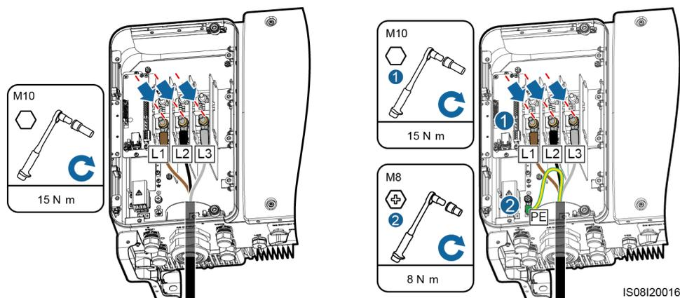
(A) Cable de tres núcleos (incluye el cable de tierra) (B) Cable de cuatro núcleos (incluye el cable de tierra)
