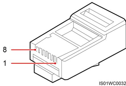
La **Tabla 5-4** enumera las definiciones de pines de un conector RJ45.
