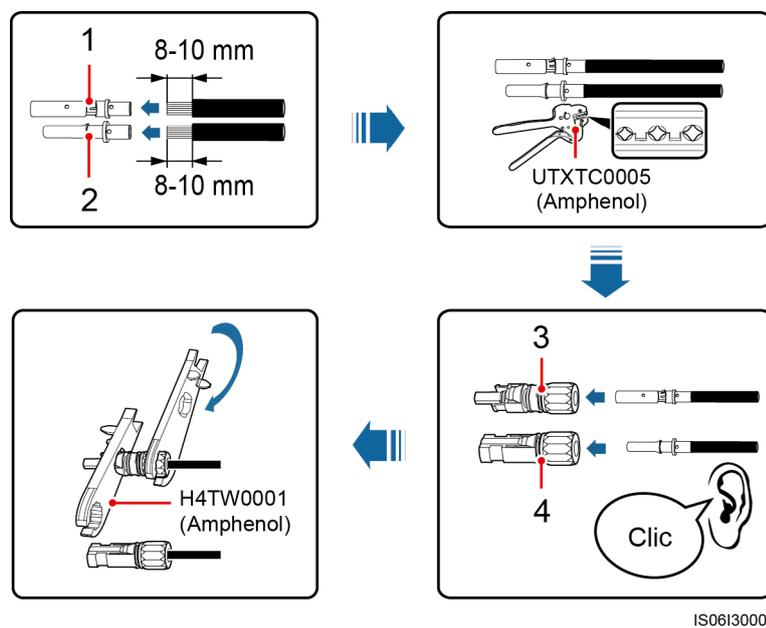
(1) Contacto metálico positivo (conformado en frío)    (2) Contacto metálico negativo (conformado en frío)
