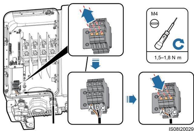
**Paso 5** Instale la cubierta de protección en los terminales de los cables
