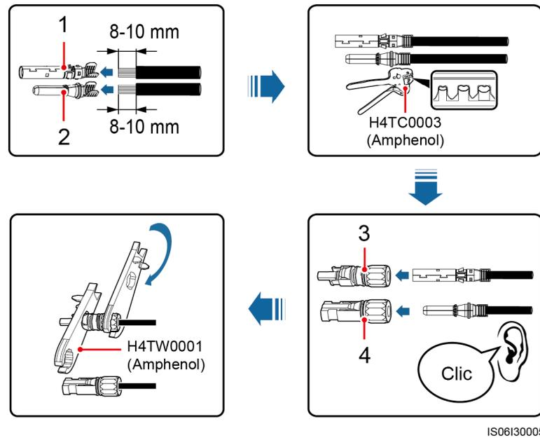
(1) Contacto metálico positivo (conformado por estampado)
