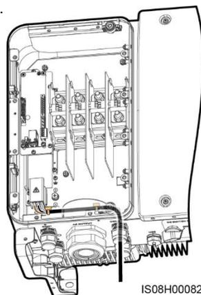
7. Serrez l'écrou de fixation indesserrable et scellez le presse-étoupe.
