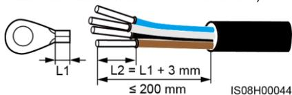
d. Câble cinq conducteurs (avec le câble de masse et le fil neutre)
