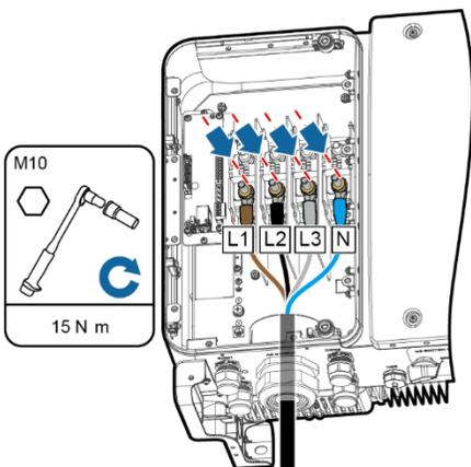
d. Câble cinq conducteurs (avec le câble de masse et le fil neutre)
