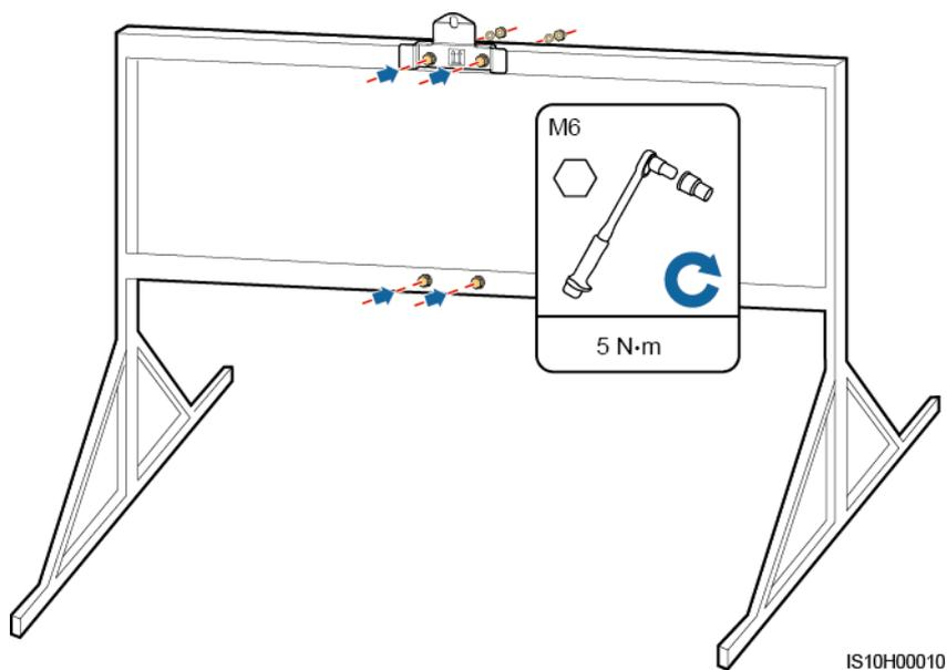
**Passo 4** Installare il SUN2000 sulla staffa di montaggio.
