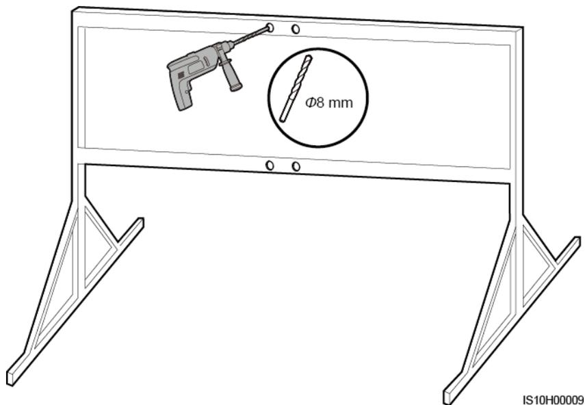
**Passo 3** Fissare la staffa di montaggio.
