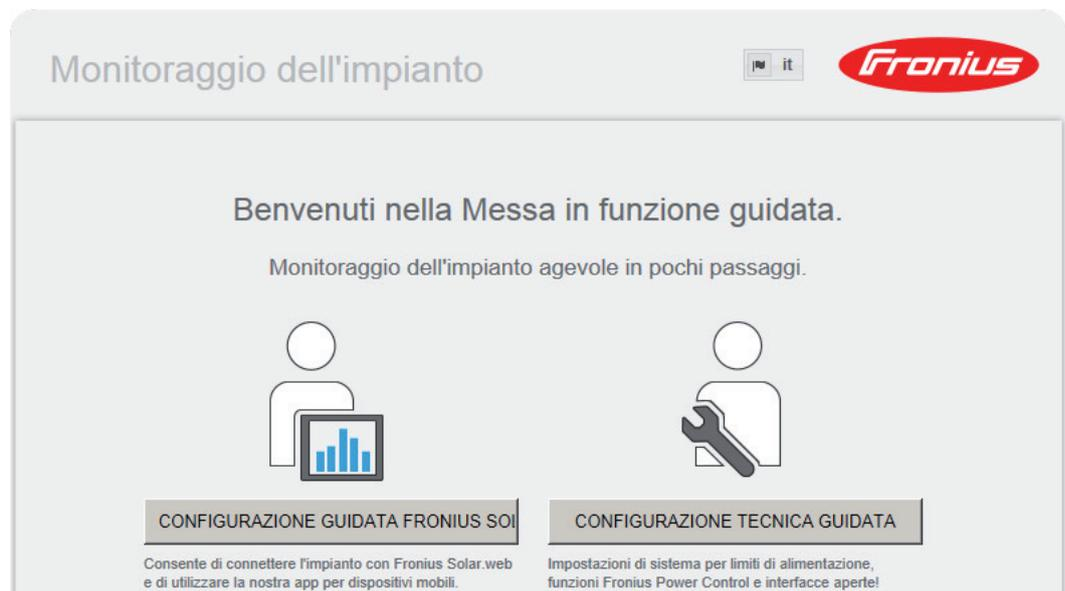
"Configurazione tecnica guidata" è prevista per gli installatori e contiene impostazioni specifiche relative alle norme. L'esecuzione di "Configurazione tecnica guidata" è opzionale. Se si esegue "Configurazione tecnica guidata", prendere assolutamente nota della password di servizio assegnata. Questa password di servizio è necessaria per impostare la voce di menu "Editor EVU".
