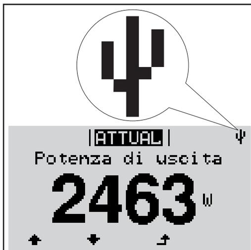
Se l'inverter riconosce uno stick USB, in alto a destra sul display viene visualizzata l'icona USB.
