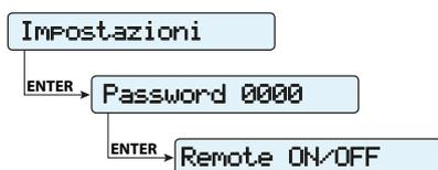
La connessione e la disconnessione dell'inverter dalla rete, possono essere comandati attraverso un comando esterno.
