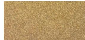
\* Risultato dei test dopo 360 ore di esposizione al cloruro di sodio.
