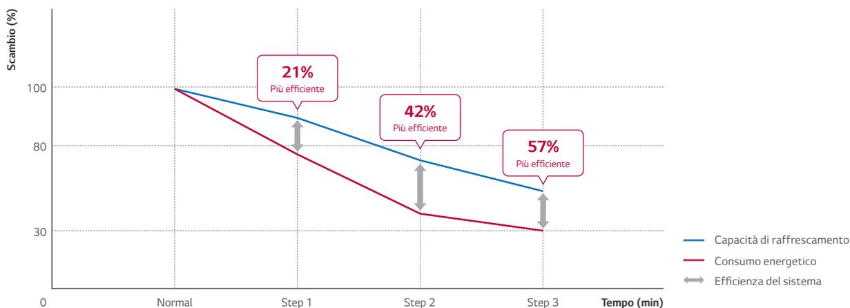
※ Condizioni di test: Temperatura interna in modalità raffreddamento 28°C, Temperatura esterna 32°C
