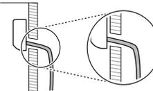
Esempio di una errata installazione del tubo di scarico
