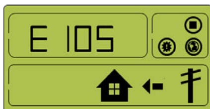
[Figura 8-17: Occorrenza di evento, protezione per sovratensione stringa PV 1]
