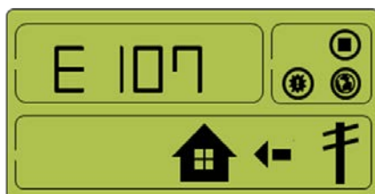
[Figura 8-19: Occorrenza di evento, protezione per sovratensione stringa PV 2]
