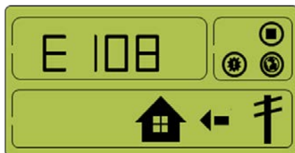
[Figura 8-20: Occorrenza di evento, protezione per sovracorrente stringa PV 2]
