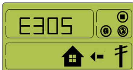
[Figura 8-28: Occorrenza di evento, evento di collegamento CC inverter e I PV normale]
