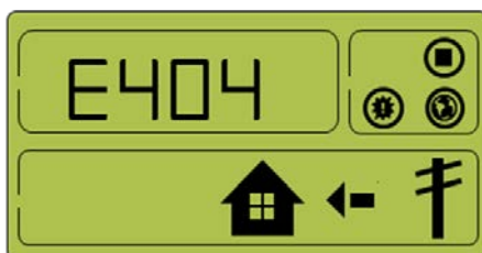
[Figura 8-32: Occorrenza di evento, errore di collegamento dei cavi PV]
