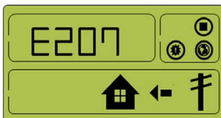
[Figura 8-25: Occorrenza di evento, evento di collegamento CC inverter normale]
