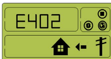
[Figura 8-30: Occorrenza di evento, guasto zona di attivazione per sovracorrente]
