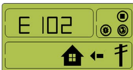
[Figura 8-14: Occorrenza di evento, protezione per sovratensione collegamento CC]
