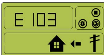
[Figura 8-15: Occorrenza di evento, protezione per collegamento inverso stringa PV 1]
