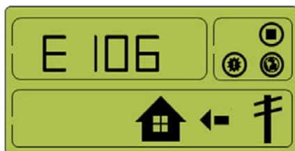
[Figura 8-18: Occorrenza di evento, protezione per sovracorrente stringa PV 1]
