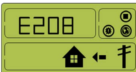
[Figura 8-26: Occorrenza di evento, evento tensione/I batteria e di collegamento CC BDC]
