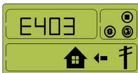
[Figura 8-31: Occorrenza di evento, errore di collegamento sensore di temperatura]
