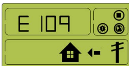
[Figura 8-21: Occorrenza di evento, protezione per sovratensione batteria]
