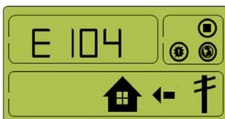
[Figura 8-16: Occorrenza di evento, protezione per collegamento inverso stringa PV 2]
