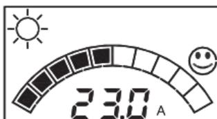
Visualizzazione della corrente d'uscita del modulo solare.
