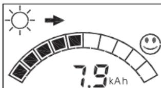
Visualizzazione della somma di amperora caricati nella batteria dalla prima installazione o dall'ultimo reset. Se entrambi i tasti vengono premuti per 3 sec. l'amperometro viene azzerato. Se si scollega la batteria il valore viene mantenuto. Al raggiungimento di 99,9 kWh l'amperometro ritorna a 0 Ah.
