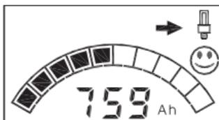
Visualizzazione della somma di amperora scaricati attraverso l'uscita carico dalla prima installazione o dall'ultimo reset. Se entrambi i tasti vengono premuti per 3 sec. l'amperometro viene azzerato. Se si scollega la batteria il valore viene mantenuto. Al raggiungimento di 99,9 kWh l'amperometro ritorna a 0 Ah.
