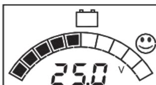
Visualizzazione della tensione della batteria misurata dal regolatore.
