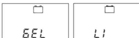
L'impostazione standard è "Li". L'impostazione del tipo di batteria influisce sulla tensione di carica finale del regolatore. Nel caso in cui si
