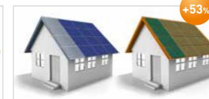
I moduli di dimensioni standard non sono in grado di coprire l'intera larghezza del tetto.
