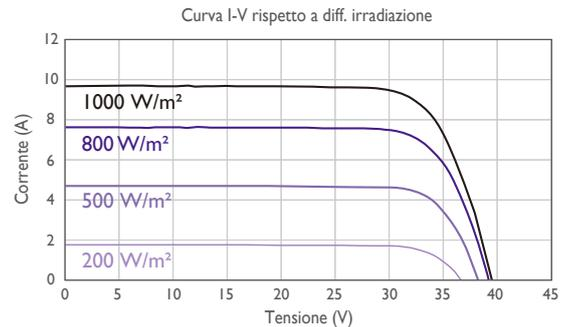
Caratteristiche di corrente/tensione con dipendenza su irradiazione e temperatura del modulo
