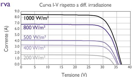
Caratteristiche di corrente/tensione con dipendenza su irradianza e temperatura del modulo
