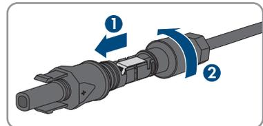
5. Poussez l'écrou-raccord jusqu'au filetage et serrez-le (couple de serrage : 2 Nm).
