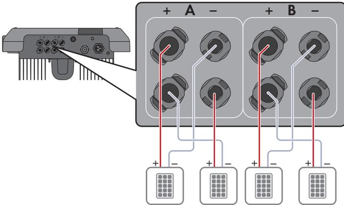
Figure 7 : Vue d'ensemble du raccordement en fonctionnement normal
