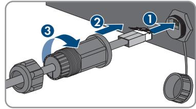
7. Vissez l'écrou-raccord sur la douille fileté.
