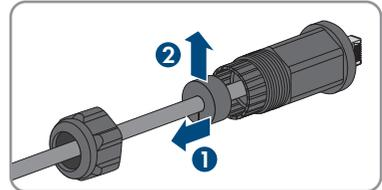
9. Sortez le câble réseau de la douille fileté et de l'écrou-raccord.
