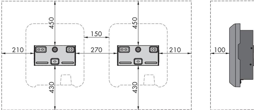
Figure 5 : Distances recommandées (Dimensions en mm)
