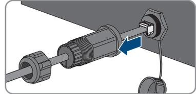
8. Sortir le manchon support de câble de la douille fileté et retirez le câble réseau du manchon support de câble.
