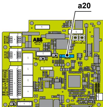
La sostituzione della batteria tampone **a20** viene fatta sulla wiring box DC ② e può rendersi necessaria in caso di:
