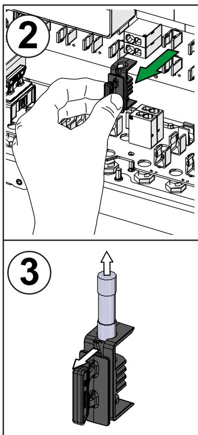
2. Rimuovere il fusibile da sostituire agendo sull'impugnatura del portafusibile
