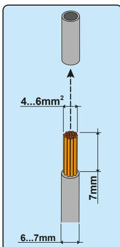
L'installazione dei connettori Weidmüller WM4 necessita di crimpatura da effettuare con l'attrezzatura adeguata.
