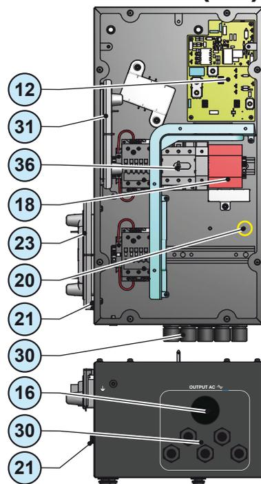
• Collegare il cavo di messa a terra sull'apposito inserto metallico filettato o terminale di terra di protezione ㉒ rispettando la sequenza illustrata nella figura. Sul cavo deve essere installato un terminale ad occhiello che deve essere dimensionato tenendo in considerazione che il punto di collegamento è un'inserto filettato dimensione M6.
