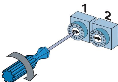
In caso lo standard di rete relativo al paese di installazione non sia nella lista è possibile verificarne la presenza tramite il software "Aurora Manager Lite", durante la prima accensione dell'inverter. Successivamente, ruotando gli interruttori a05, verrà visualizzato lo standard di rete relativo alla posizione impostata.
