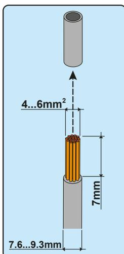
L'installazione dei connettori Amphenol H4 necessita di crimpatura da effettuare con l'attrezzatura adeguata.
