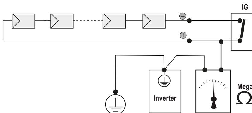
**MODELLI -TL (senza trasformatore di isolamento).** Se la resistenza di isolamento misurata (Riso) è minore di 500 KOhm l'inverter non si connette in rete a causa di un basso isolamento del generatore FV verso terra.
