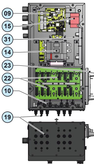
All'interno della wiring box DC ⑫ installata nei modelli di inverter -SX/-SY sono presenti due schede su cui sono installati i fusibili stringa:
