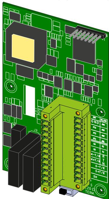
L'inverter è dotato del connettore a23 (J18) dedicato all'installazione della scheda di espansione PMU (opzionale).
