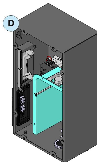
• Prima di procedere al montaggio delle wiring box sulla staffa devono essere installate le 2 staffe per collegamento di terra <sup>32</sup> sui punti di fissaggio <sup>37</sup> dedicati (uno per ogni wiring box) ed evidenziati dal simbolo ⚡.
