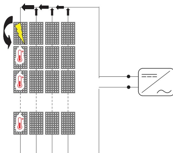
In queste versioni di wiring box è necessario connettere direttamente le singole stringhe in ingresso all’inverter (non effettuare quadri di campo per il parallelo delle stringhe). Questo perché i fusibili stringa 10 lato (+) positivo e 22 lato (-) negativo, posti su ogni ingresso, non sono dimensionati per accogliere stringhe in parallelo (array).
