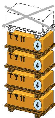
L'imballo del modulo di conversione se correttamente conservato, può sopportare un carico massimo di 4 apparecchiature (suddivise in 4 pallet).
