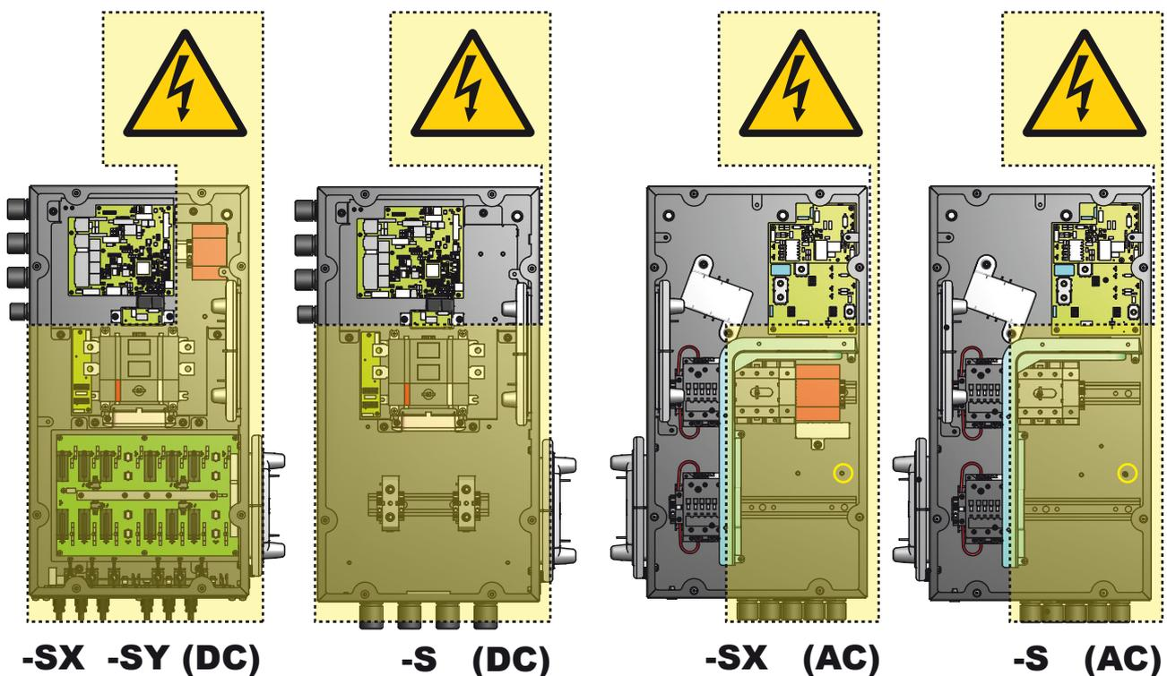
6 Aprire il sezionatore DC e il sezionatore AC installati a cura del Cliente esterni all'inverter.
