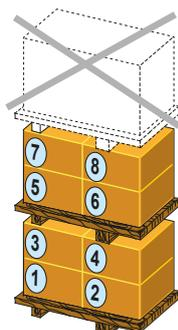
L'imballo della wiring box se correttamente conservato, può sopportare un carico massimo di 8 apparecchiature (suddivise in 2 pallet).
