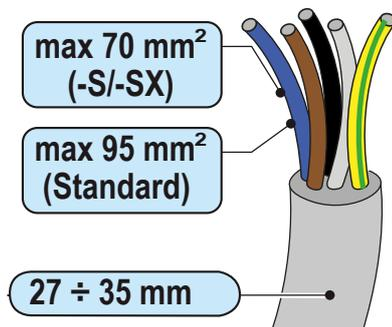
La sezione del conduttore di linea AC deve essere dimensionato al fine di evitare indesiderate disconnessioni dell'inverter dalla rete di distribuzione dovute ad elevate impedenze della linea che collega l'inverter al punto di fornitura dell'energia elettrica; Infatti se l'impedenza è troppo alta provoca un'innalzamento della tensione AC che, raggiunto il limite imposto dalle norme del paese d'installazione, provoca il disinserimento dell'inverter.
