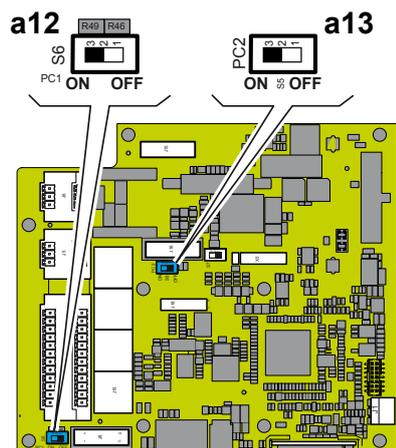
In caso di collegamento di un singolo inverter al sistema di monitoraggio, attivare la resistenza di terminazione della linea di comunicazione mediante commutazione dell'interruttore **a12** o **a13** (in posizione ON). Impostare su ciascun inverter della catena un indirizzo RS485 diverso. **Nessun inverter dovrà avere come indirizzo "Auto"**. Si può scegliere liberamente un indirizzo tra 2 e 63. Il settaggio dell'indirizzo sull'inverter si effettua attraverso il software "Aurora Manager".
