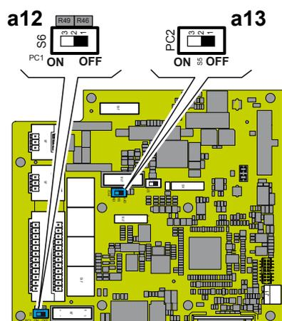
Quando si utilizza un collegamento RS-485, se uno o più inverter vengono aggiunti successivamente al sistema bisogna ricordarsi di riportare in posizione OFF l'interruttore della resistenza di terminazione utilizzata (1) o (2) dell'inverter che in precedenza era l'ultimo del sistema. Ciascun inverter viene spedito con indirizzo RS485 predefinito due (2) e con Interruttore per il settaggio della resistenza di terminazione **a12** o **a13** in posizione OFF.
