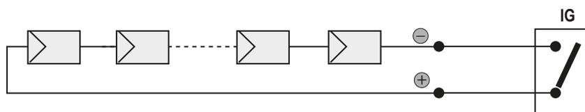
Una volta effettuato il cortocircuito provvedere a misurare la resistenza di isolamento (Riso) utilizzando un megaohmetro posizionato fra i due poli in cortocircuito e terra (dell'inverter).
