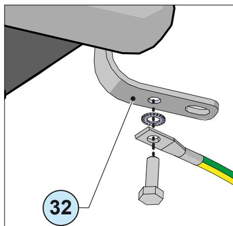
Utilizzare vite e rondella di M6 per il fissaggio del cavo provvisorio di terra (non fornite a corredo)
