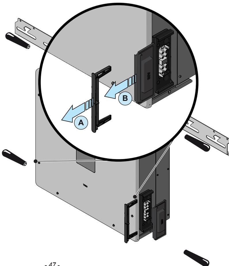
• Ruotare il sezionatore posto sulle wiring box in posizione 0 (zero) altrimenti non è possibile togliere il coperchio frontale 08.
